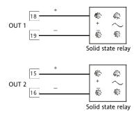
Fig. 11 – SSR DRIVE OUTPUT WIRING
