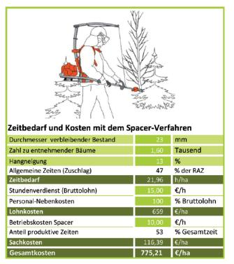
Kalkulationsschema zur Herleitung des Zeitbedarfes pro Fläche beim Einsatz des Spacers. Die zu berechnenden Werte in der Kalkulationshilfe sind dunkelgrün hinterlegt.
