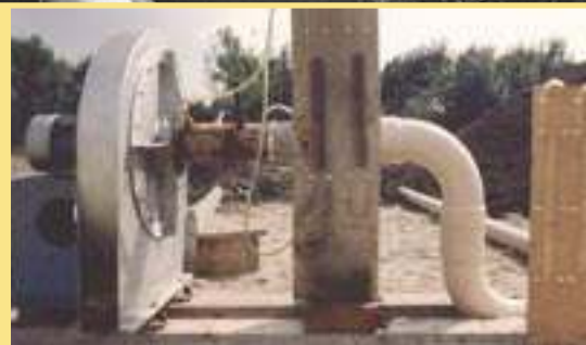
Met een grote ventilator en buizen werd lucht door de rillen geblazen
